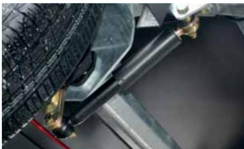
Amortisseurs (montés) avec certification 100km/h – valable uniquement pour l'Allemagne. Amortisseurs (non montés) sans certification 100km/h
