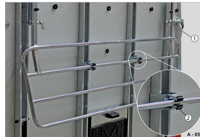
Fig. 58 Levée de la grille poulain
