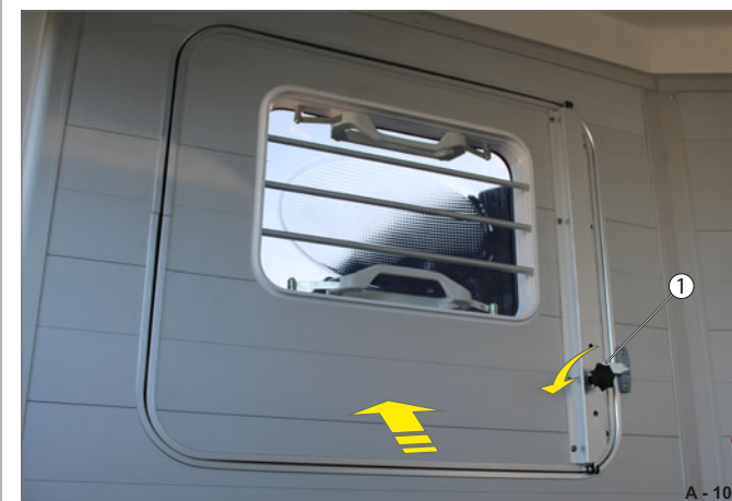
Fig. 101 Ouverture de la fenêtre d'aération de l'intérieur
