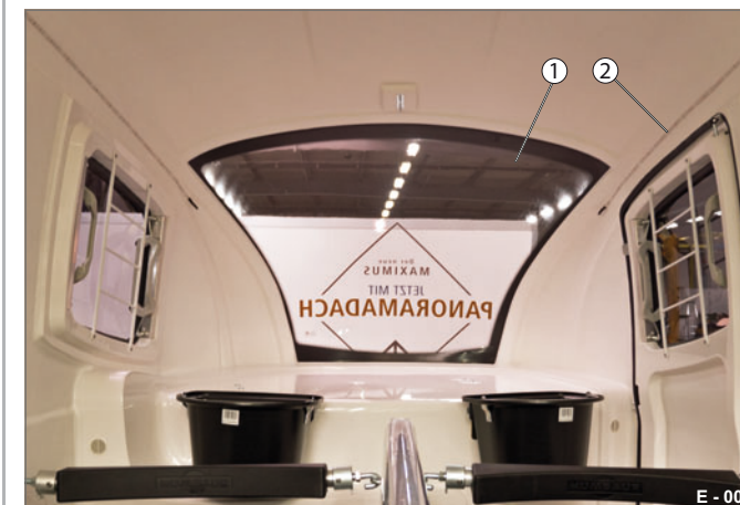
Fig. 9 Vue de l'intérieur du toit panoramique
