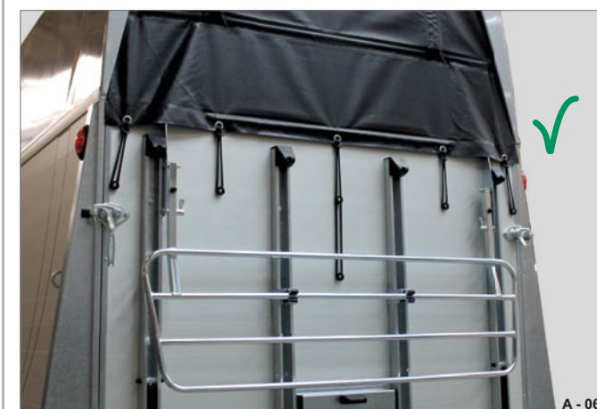
Fig. 63 Grille poulain abaissée et sécurisée
