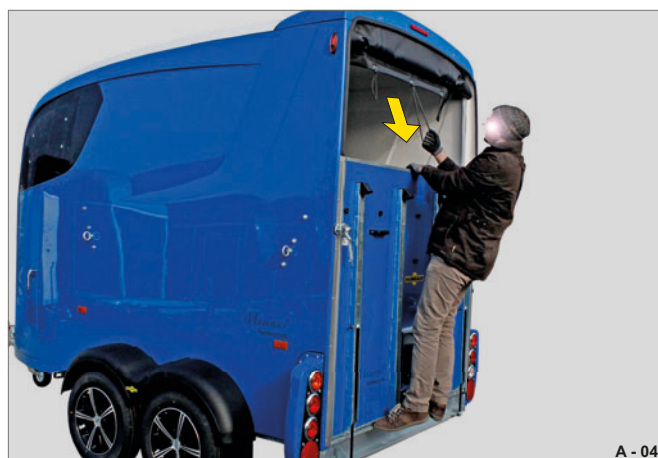
Fig. 47 Déploiement du Windschott / de la bâche
