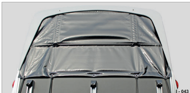
Fig. 43 Bâche à la place du filet roulant
