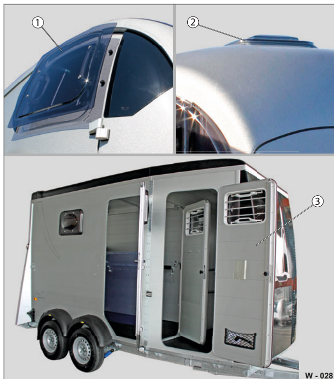
Fig. 28 Aération / séchage du van
