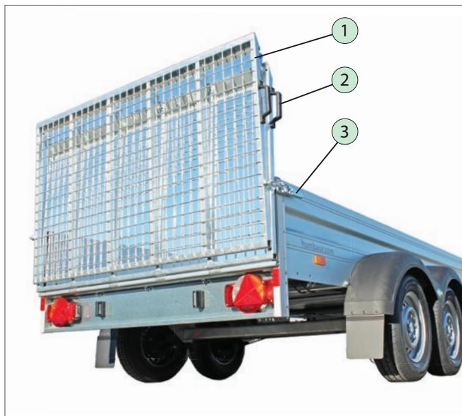
Pont arrière grillagé, fermé (position de conduite)
