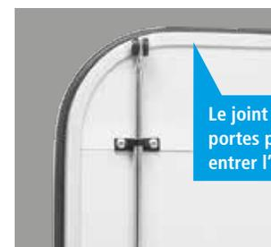
Le joint en caoutchouc sur les portes permet de ne pas laisser entrer l'humidité
